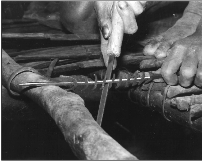
Figure 13. Filing a ginəlgəl with a triangular file.
